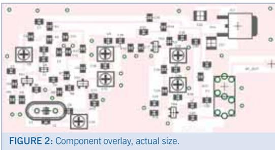
FIGURE 2: Component overlay, actual size.
